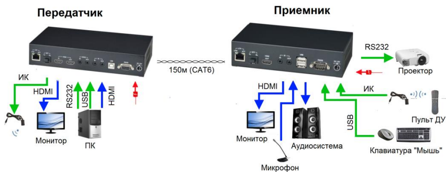
Рис. 9 Подключение передатчиков и приемников «точка-точка».
